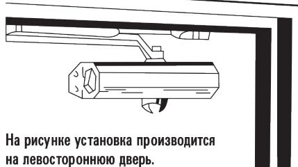
На рисунке установка производится на левостороннюю дверь.
